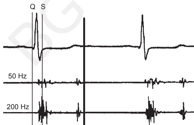
Rys. 7.1. Fonokardiogram prawidłowy zapisany w dwóch pasmach częstotliwości
