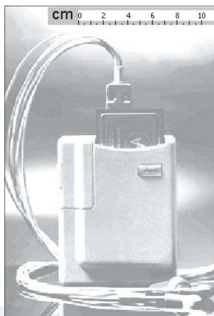
Rys. 6.21. Rejestrator holterowski z pamięcią stałą
